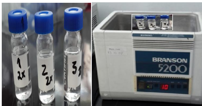
Gambar 8 : larutan sampel yang sudah disaring dan dimasukkan ke Branson 5200 untuk proses degassing \pm 5 menit
