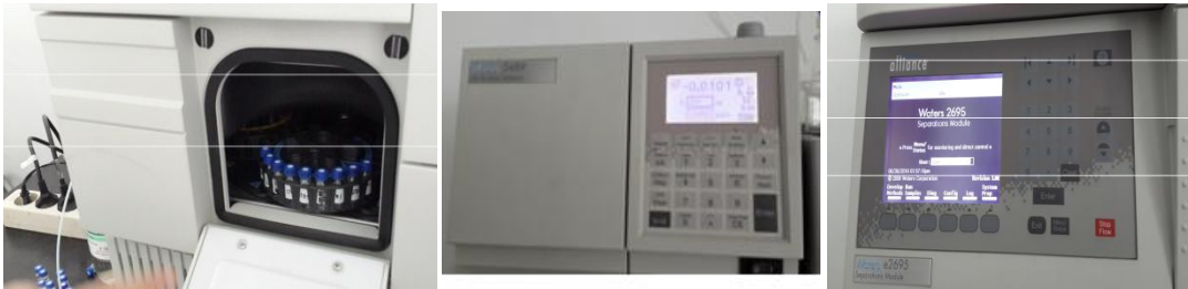
Gambar 9: Penyusunan vial didalam kolom HPLC dan monitor alat HPLC
