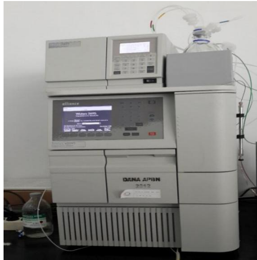
Gambar 1 : Alat HPLC Waters Alliance2695HPLCSeperationsModuleColumn Compartment & Water 2489UV/Visible Detector dilengkapi dengan kolom C-18, diameter 5 \mu l, ukuran 4,6 x 150 mm yang terhubung dengan monitor
