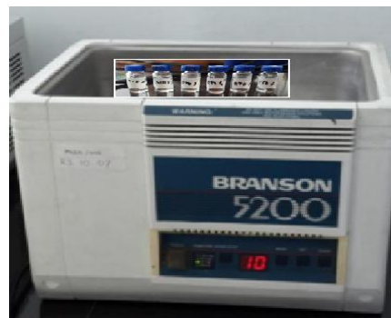
Gambar 5 : proses degassing dengan alat Branson 5200 ultasonic cleaner
