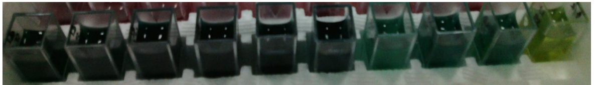
Gambar 2 : Kuvet urea dari blanko, standar, factor 2 sampai 128 dan sampel
