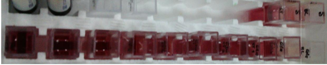
Gambar 4 : Kuvet urea dari blanko, standar, factor 2 sampai 128 dan sampel
