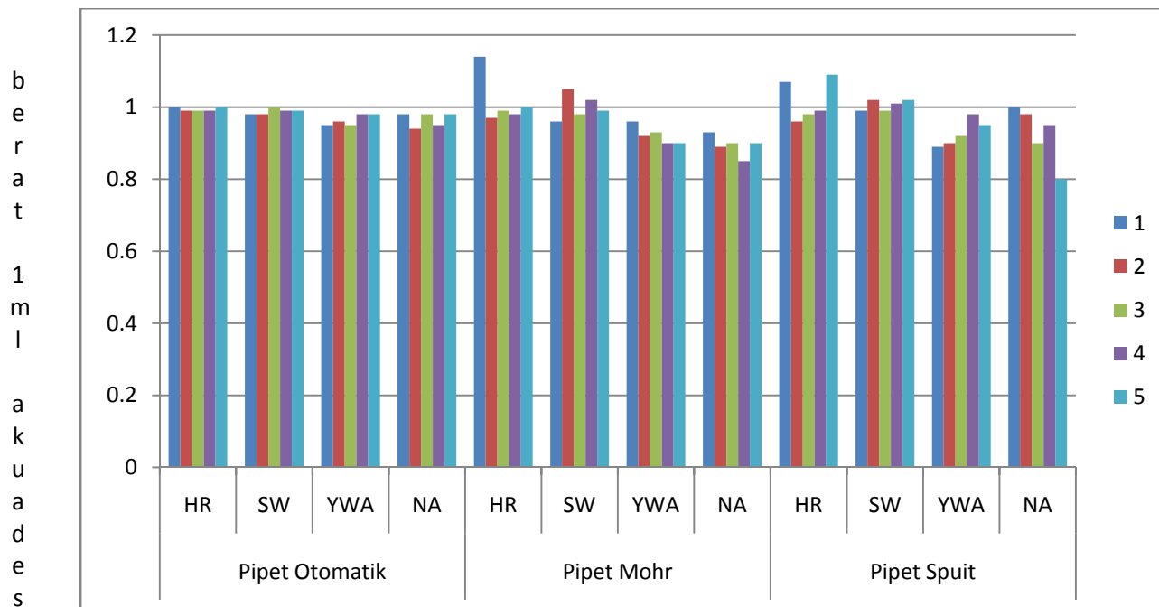
Grafik hasil penimbangan 1 ml akuades dengan pipet sduit, pipet mohr, dan pipet otomatis
