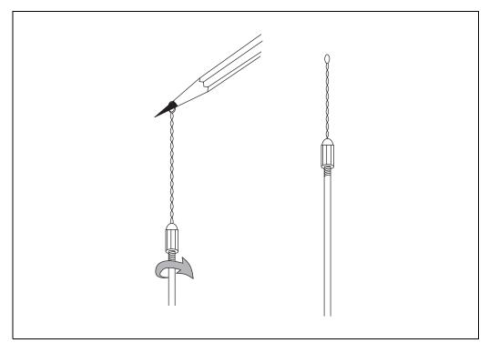
Figure 1.1.1 Making a loop.
