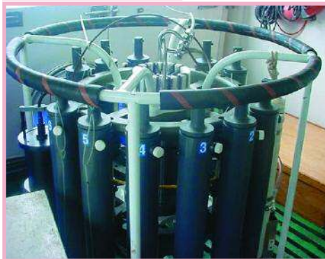
FIGURA 9 Detalle de la roseta de botellas Niskin con sensores
