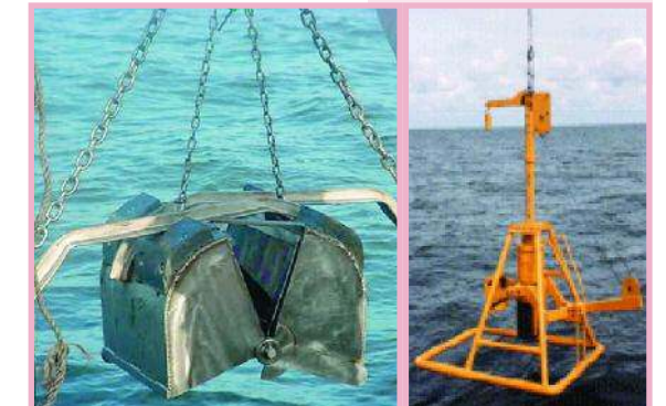
FIGURA 11 Equipos de muestreo para las comunidades bentónicas: a) draga Van Veen y b) nucleador
