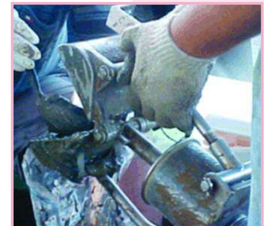
FIGURA 12 Equipo de muestreo para las comunidades bentónicas costeras: draga manual
