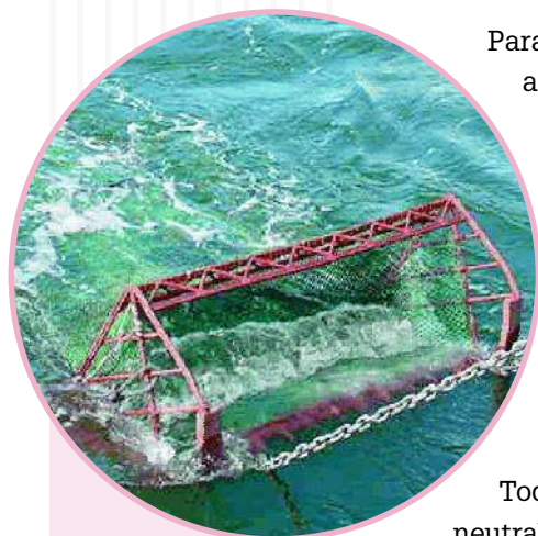
FIGURA 13 Equipo de muestreo para las comunidades megabentónicas: rastra Beam Trawl
