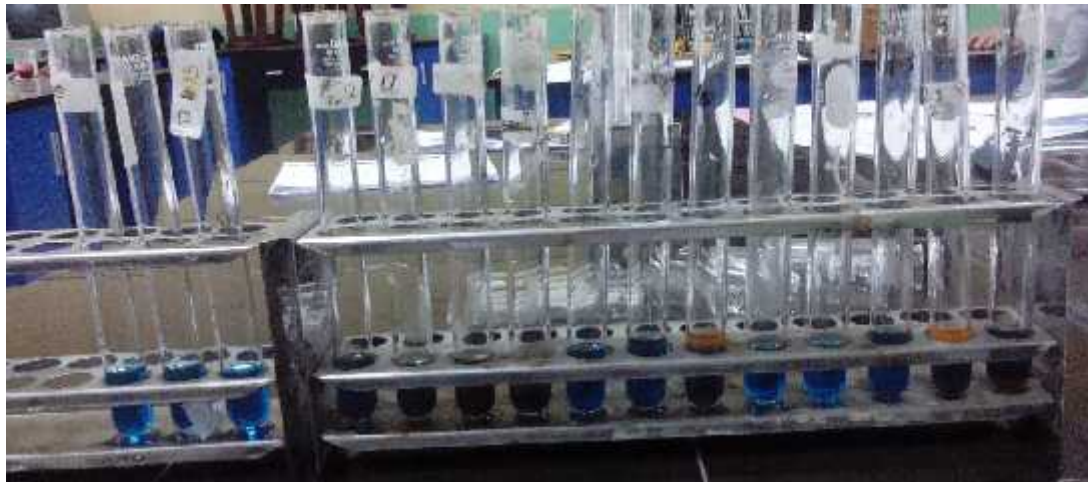
Gambar 5 : Tabung reaksi yang berisi 5ml benedict yang telah ditambahkan 8 tetes larutan glukosa yang telah diencerkan dan telah dipanaskan didalam waterbath
