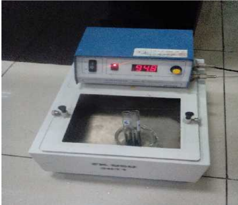
Gambar 4 : tabung benedict 5 ml yang telah ditambah dengan 8 tetes larutan glukosa 5% dipanaskan dalam waterbath selama 5 menit
