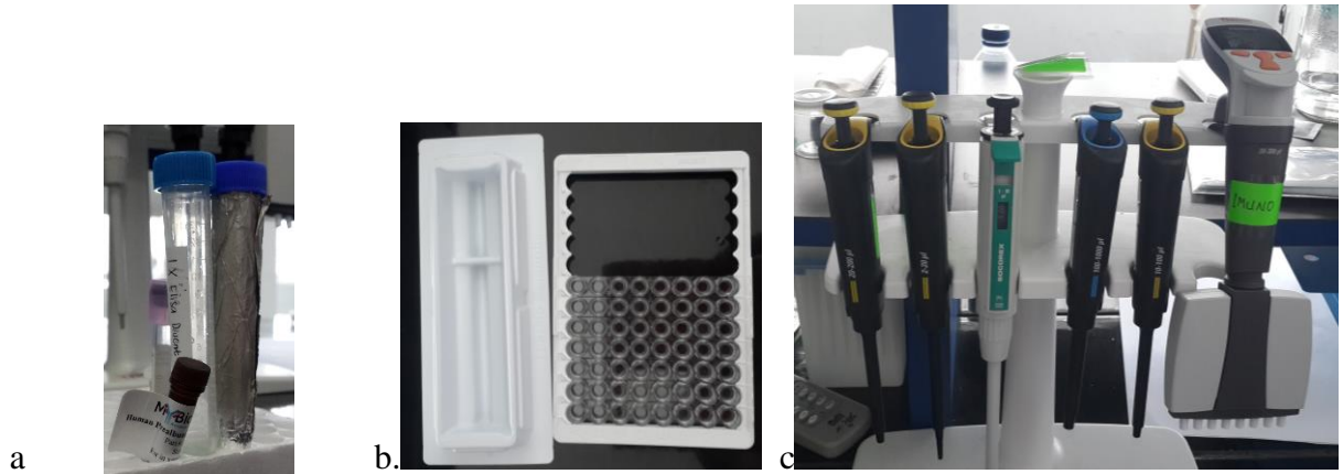
Gambar 7. a. Stok 100x enzyme-antibody conjugate - 1x diluent solution - Pengenceran enzyme-antibody conjugate dengan diluent solution pada tabung yang dilapisi aluminium foil. b. multichannel pipette reservoir digunakan sebagai tempat mengambil bahan menggunakan multichannel mikropipette. c. berbagai micropipette baik single channel maupun multichannel
