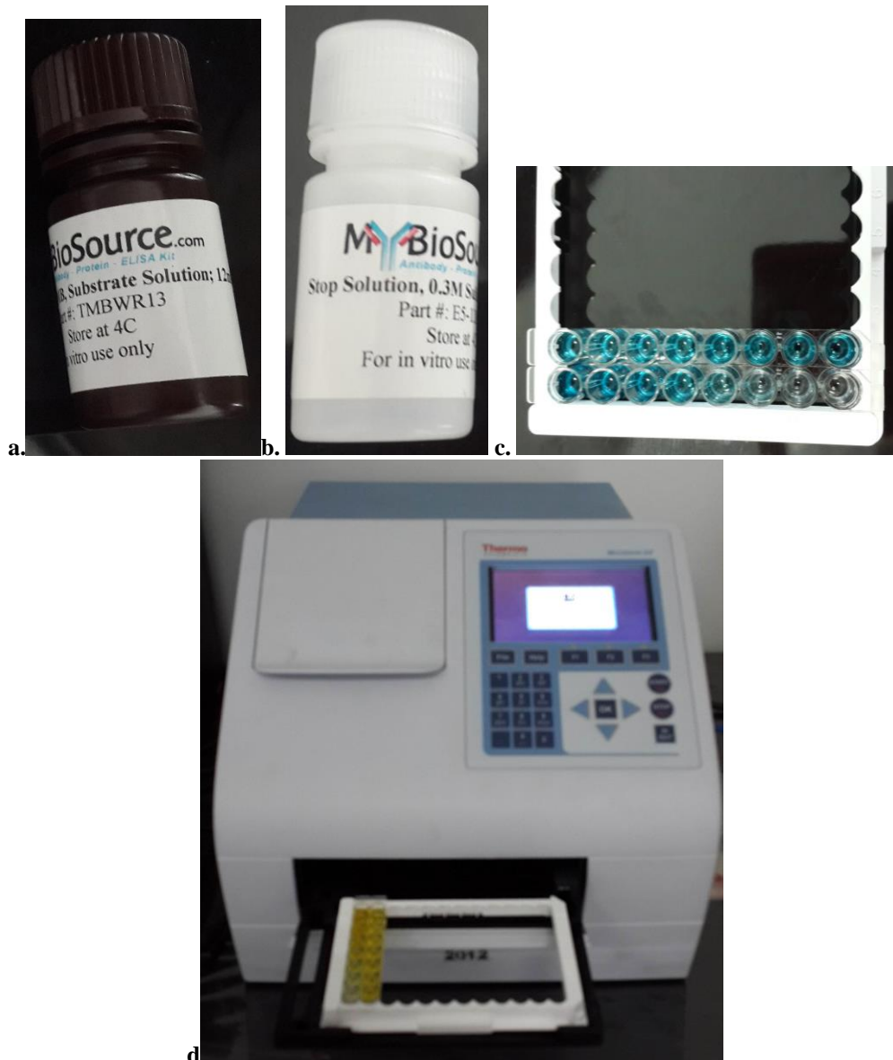
Gambar 8. a. Stok TMB Substrate Solution b. Stop Solution c. Standard dan sampel berwarna biru sebelum diberikan substrat d. setelah pemberian substrat dan stop solution menjadi berwarna kekuningan dan diperiksa menggunakan ELISA Reader Multiskan GO
