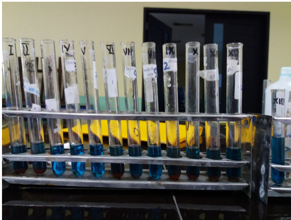
Gambar 2. Tabung reaksi yang berisi 2,5ml benedict dan 8 tetes larutan glukosa 5 % yang telah diencerkan, setelah dipanaskan dan dibiarkan dingin.
