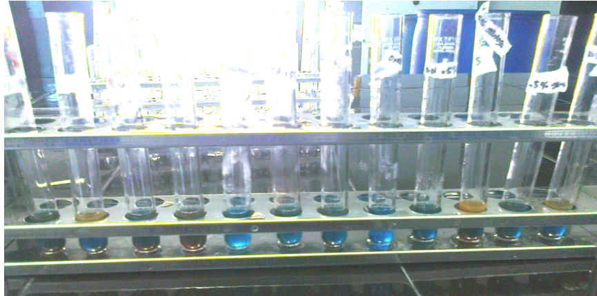
Gambar 2. Larutan benedict sebanyak 2,5 ml ditetesi dengan glukosa 5% yg telah diencerkan yang mengalami perubahan dan dipanaskan dalam waterbath selama 5 menit.
