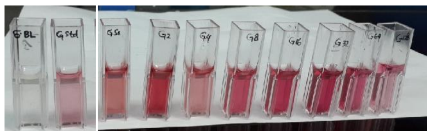
Gambar 9. (ki-ka) kuvet blanko, kuvet standard kit glukosa, kuvet stok, kuvet F2, kuvet F4, kuvet F8, kuvet F16, kuvet F32, kuvet F64 dan kuvet 128
