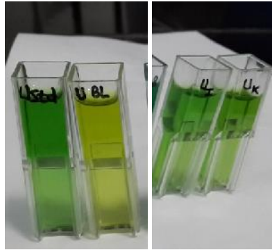
Gambar 7. (ki-ka) kuvet standard kuvet blanko, kuvet sampel irma dan kuvet sampel karin
