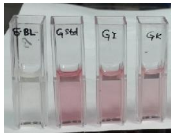
Gambar 12. (ki-ka) kuvet blanko, kuvet standard , kuvet sampel irma dan kuvet sampel karin
