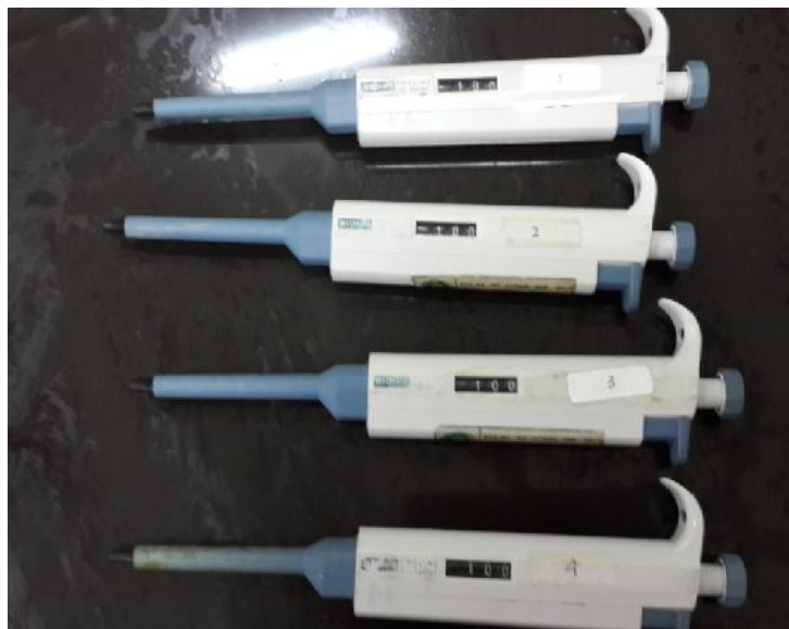
Gambar 6. Pipet Otomatik dengan volume 10-100 \mu l
