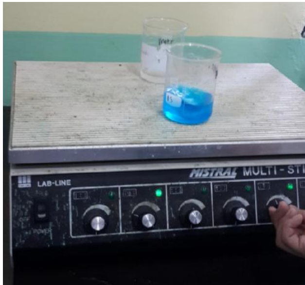
Gambar 10. Multi Stirrer untuk melarutkan bahan kimia di dalam larutan
