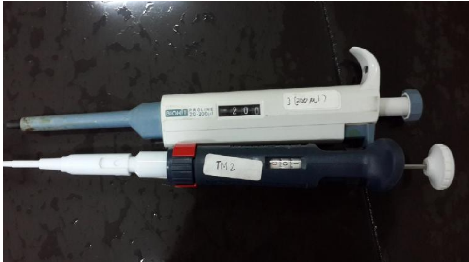
Gambar 7. Pipet otomatis berukuran 20-200 µl (atas) dan 1-10 µl (bawah)
