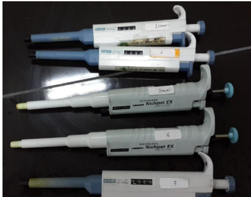
Gambar 5. Pipet Otomatik dengan volume 100-1000 \mu l
