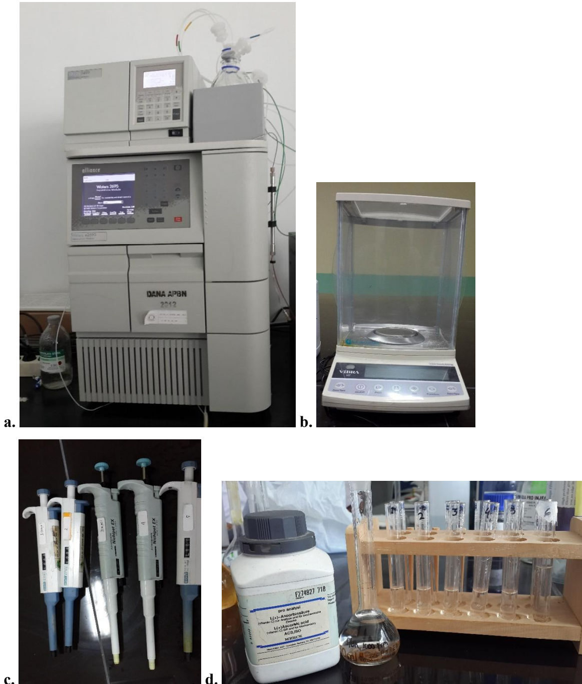
Gambar 2. a. Persapan fase gerak (500 mL larutan 55% air yang terdiri dari 45% metanol dan ditambahkan 6 tetes 6 M H 2 SO 4 ditempatkan pada botol dan disambungkan pada selang yang terhubung pada alat HPLC) serta alat HPLC (Waters® Alliance 2695 HPLC Separations Module Column Compartment & Waters® 2489 UV/Visible Detector); b. Timbangan digital ( Digital Scale and Balance ). c. Micropipette berukuran 100-1000 µl d. Asam askorbat, larutan induk asam askorbat 1000 ppm dalam labu erlenmeyer serta serial/double dilution faktor 2,4,8, 16 dan 32
