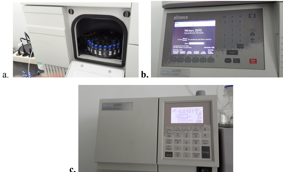
Gambar 4. a. Memasukkan vial ke dalam alat HPLC b. display layar alat HPLC Waters® Alliance 2695 HPLC Separations Module Column Compartment c. display layar Waters® 2489 UV/Visible Detector
