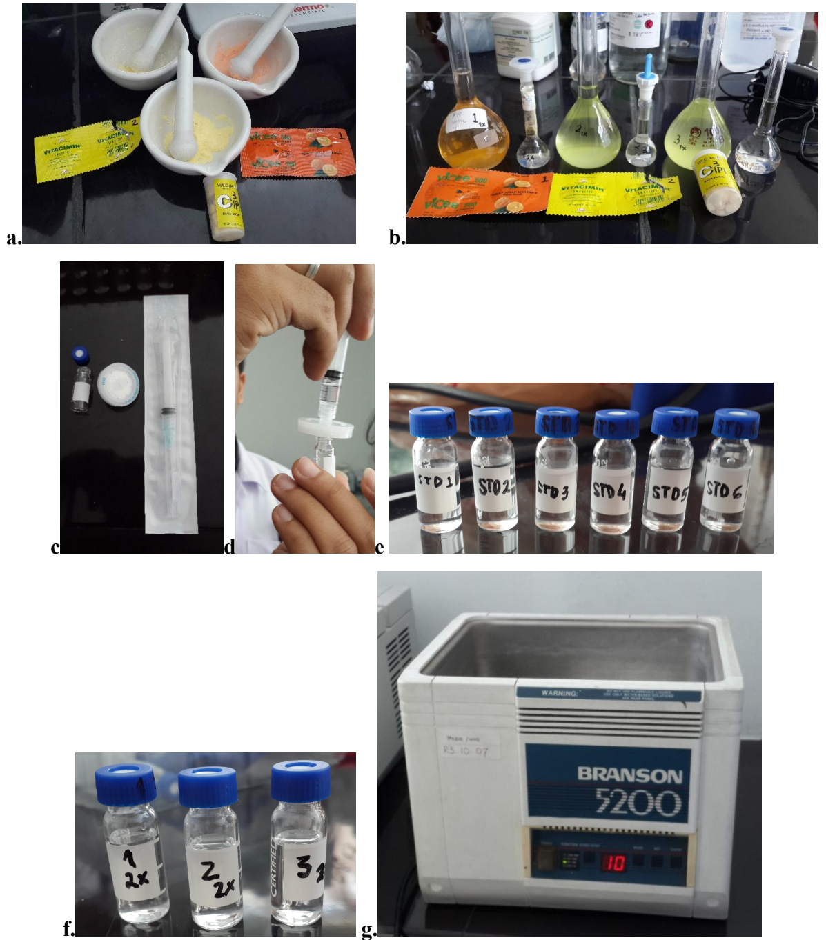
Gambar 3. a. 3 sampel vitamin C digerus halus b. tiap sampel ditimbang sebanyak 300 mg dan dibuat larutan hingga 100 ml, 10 ml aliquot larutan tersebut diambil dan diencerkan kembali dengan menambahkan air hingga 100 ml (berhubung labu erlenmeyer yang tersedia untuk pengenceran kedua berukuran 10 ml, maka aliquot yang diambil sebanyak 1 ml, dan untuk labu berukuran 25 ml maka aliquot yang diambil sebanyak 2,5 ml) c. vial, saringan milipore dan spuit d. Menyaring sampel dan standar serta memasukkan ke dalam vial e. Standard 1-6 di dalam vial f. Sampel 1, 2 dan 3 dalam konsentrasi 300 mg/10.000ml g. Branson 5200 Ultrasonic Cleaner untuk melakukan degassing vial
